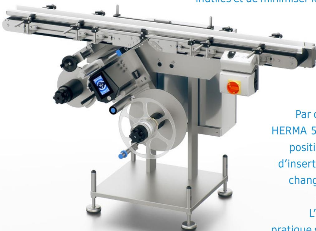
Par conséquent, le dispositif HERMA 500 peut être facilement positionné à la main en mode d'insertion et de travail pour un changement rapide et simple du rouleau d'étiquettes. L'élément convoyeur très pratique se charge également de l'apposition des étiquettes, éliminant ainsi le besoin de tourner les produits.
