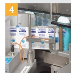
Des indicateurs de position électroniques et des réglages motorisés de la hauteur soutiennent le changement rapide de format et permettent des temps d'équipement très courts.
